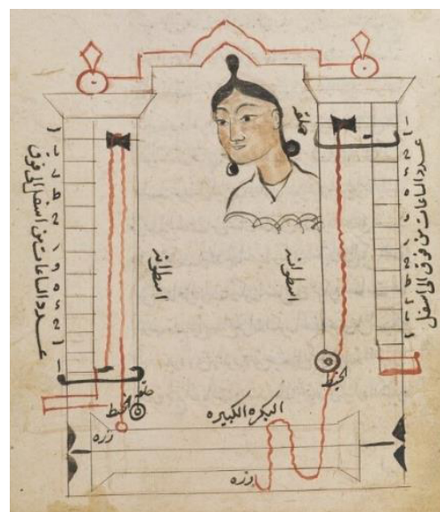
شکل ۳. بخشی از یک ساعت آبی مکانیکی، کتاب اُرشمیدس فی البنکامات، سده دهم/شانزدهم، کتابخانه بریتانیا (شماره Add 23391، گ ۱۱).
