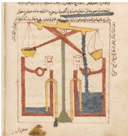
شکل ۱۴. دستگاهی برای بالاکشیدن آب، فی معرفه الحیل الهندسیه، جزری، ۹۶۹ق، کتابخانه دانشگاه لایدن (شماره 656، Or. گ 161پ)، (Digital Collections, University Leiden, n.d)
